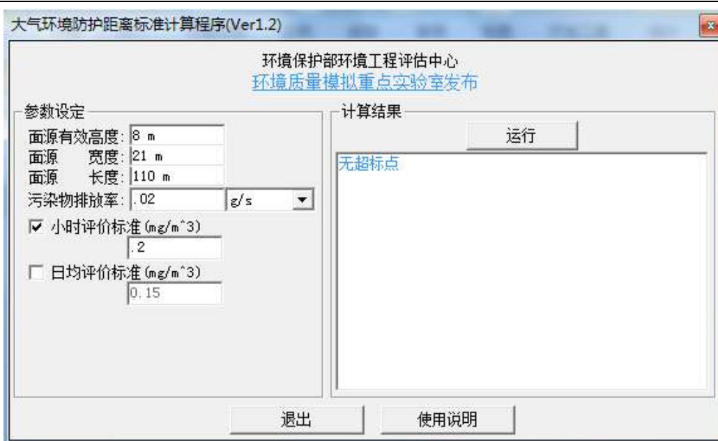
图 7-1 氨气大气防护距离计算
